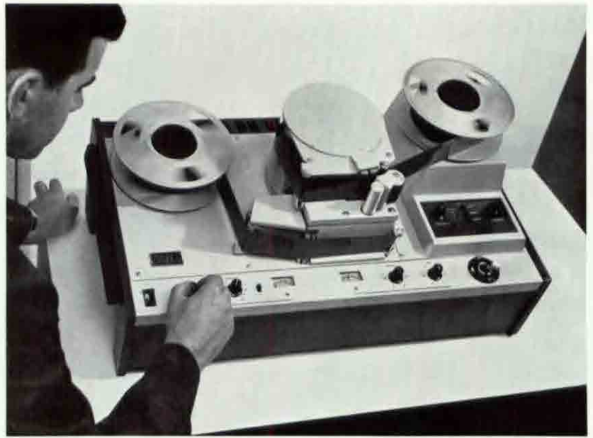
Volltransistorisierte tragbare Magnetbild-Aufzeichnungsapparatur. Solche Anlagen müssen allerdings für den professionellen Einsatz noch etwas weiter entwickelt werden.
