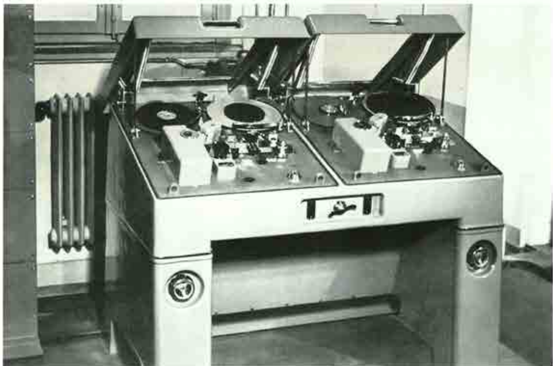
Filmaufnahme- und -wiedergabe-Gerät Philips-Miller
